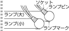
大きいランプから、ランプマークを下側にしてランプ支持パネに取付け、ランプピンをソケットに確実に差し込む。
