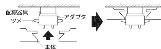
△警告 解除レバーの緑の矢印の先端が、アダプタの赤い矢印の先端にくるまで本体を押し上げてください。取付けが不完全な場合、落下によるけがの原因になります。
