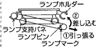
ランプホルダー ランプマークを下側にしてランプ支持パネに取付け、ランプピンをランプホルダーに確実に差し込む。
