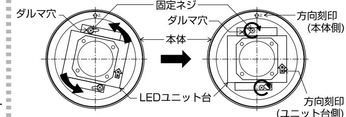
③ 固定ネジを締め付ける
