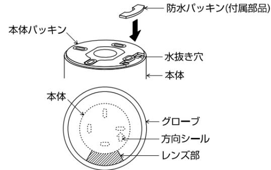
■施工手順 △注意 取付けの際は必ず電源を切ってください。感電の原因になります。
