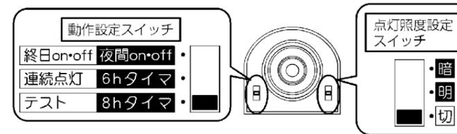
①電源投入後、約20秒間点灯し、その後は明るくても人を感知することに約5秒間点灯します。結線および負荷の作動を確認できます。
