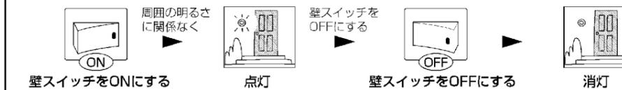
※電源投入後、約20秒間点灯し、その後約40秒間は明るくても人を感知することにより約5秒間点灯します。電源投入から約60秒後に一旦消灯し設定したモードになります。(連続点灯モードを除く。)
