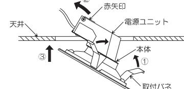
※天井材厚が薄い場合、天井との間にすきまが空くことがありますので、この場合は一度バネを押し広げてから埋込穴に挿入してください。
