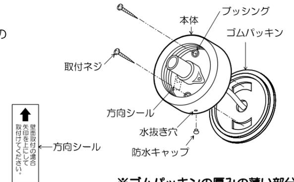
※ゴムパッキンの厚みの薄い部分と取付ネジの位置を合わせてから取付けてください。
