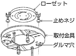
取付金具の矢印(▶◀)を止めねじに合わせて締め付ける。
