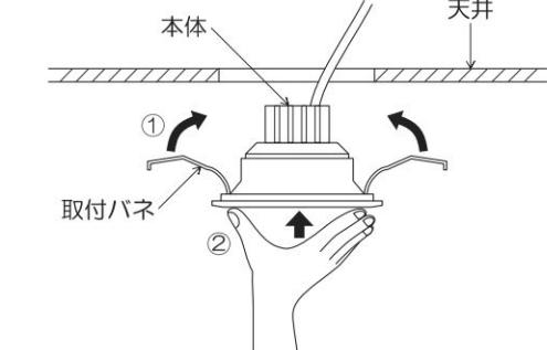
※天井材厚が薄い場合、天井との間にすきまが空くことがありますので、この場合は一度バネを押し広げてから埋込穴に挿入してください。
