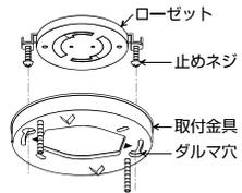
取付金具の矢印(◀▶)を止めネジに合わせて締め付ける。
