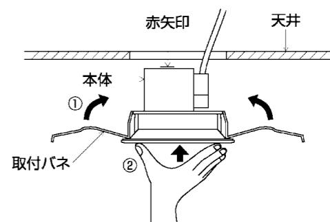
\*天井材厚が薄い場合、天井との間にすきまが空くことがありますので、この場合は一度バネを押し広げてから埋込穴に挿入してください。
