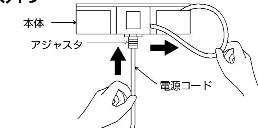
②押し込んだ電源コードを本体側面で束ね、コード押さえに引っかける。
