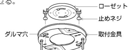
取付金具の矢印(s t)を止めねじに合わせて締め
