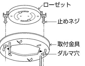
取付金具の矢印(◀▶)を止めねじに合わせて締め
