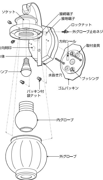
ゴムパッキン、取付金具に電源線を通し、方向シールの指示に従って取付ネジで取付ける。
