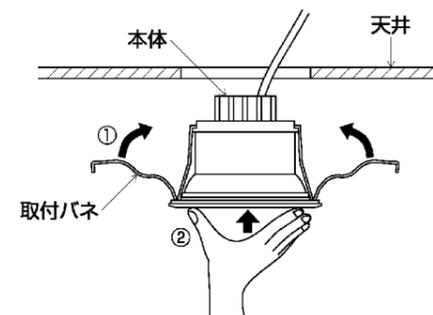
※天井材厚が薄い場合、天井との間にすきまが空くことがありますので、この場合は一度バネを押し広げてから埋込穴に挿入してください。
