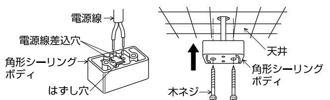
■取付手順 △注意 取付けの際は必ず電源を切ってください。感電の原因になります。
