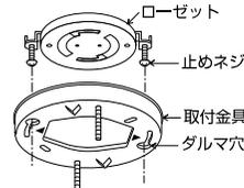
取付金具の矢印(t s)を止めネジに合わせて締め付ける。
