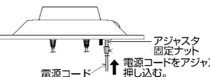
※電源コードの調整が固い場合は、一旦、固定ナットをアジャスターから取り外し、もう一度2回転程締め付け、仮止めしてください。
