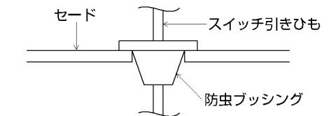
セードを天板に合わせ、6ヶ所すべての止め金具を回して取付ける。
