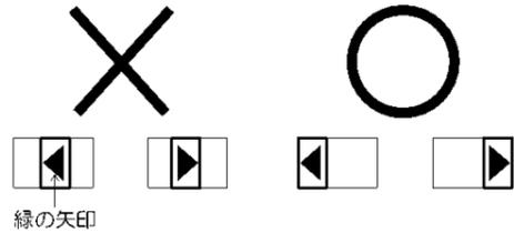
△警告 緑の先端が両端にくるまで本体を押し上げててください。取付けが不完全な場合、落下によるけがの原因になります。
