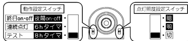
①電源投入後、約50秒間点灯し、その後テストモードになります。人を感知することにより点灯時間が延長しますが、電源投入から約60秒後に一旦消灯し、テストモードになります。テストモードは人を検知することにより約6秒間点灯します。結線および負荷の作動を確認できます。
