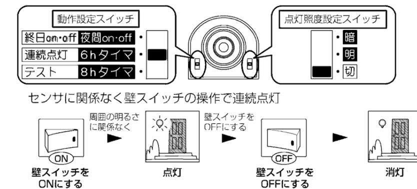
※電源投入後、約50秒間点灯し、その後センサ待機モードになります。人を感知することにより点灯時間が延長しますが、電源投入から約60秒後に一旦消灯し、センサ待機モードになります。(連続点灯モードを除く。)
