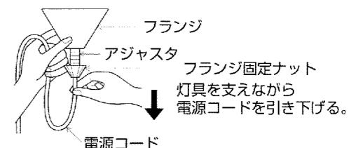
※電源コードの調整が固い場合は、一旦、フランジ固定ナットをアジャスタから取り外し、もう一度2回転程締め付け、仮止めしてください。
