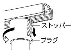
△警告 プラグのストッパーを操作する際は慎重に行ってください。プラグが損傷すると火災・落下によるけがの原因になります。
