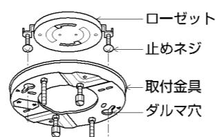
取付金具の矢印(s t)を止めネジに合わせて締め付ける。
