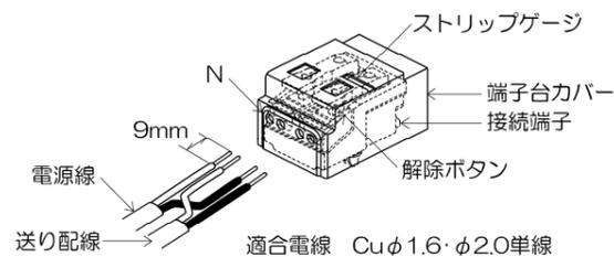
△警告 電源の接続は確実に行ってください。端子台カバーを外さずに電源線を接続してください。接続が不完全な場合や電源線が器具に接触した場合、容量オーバーした場合は火災・感電の原因になります。
