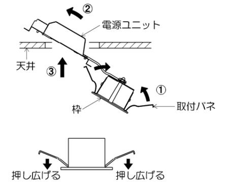
※天井材厚が薄い場合、天井との間に隙間が空くことがありますので、この場合は一度ハネを押し広げてから埋込穴に挿入してください。
