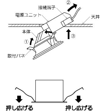
※天井材厚が薄い場合、天井との間にすきまが空くことがありますので、この場合は一度バネを押し広げてから埋込み穴に挿入してください。
