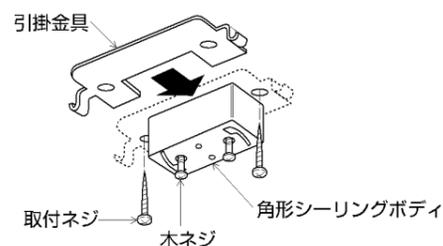
■ 取付手順 △ 注意 取付けの際は必ず電源を切ってください。感電の原因になります。
