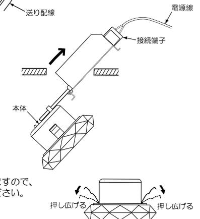
※天井材厚が薄い場合、天井との間に隙間が空くことがありますので、この場合は一度パネを押し広げてから埋込穴に挿入してください。
