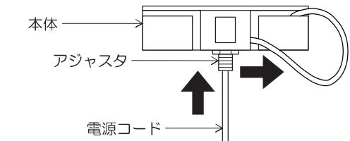
②押し込んだ電源コードを本体側面で束ね、コード押さえに引っ掛ける。
