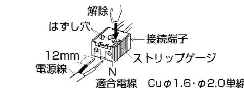
電源接続をする際は壁スイッチを必ず設ける。
