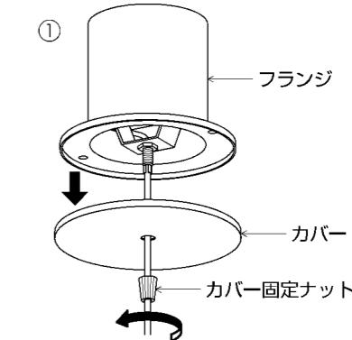
②電源コードを持ち上げながら長さを調整し、電源コードをフランジ内に収納する。
