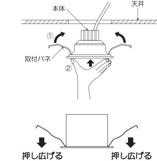
※天井材厚が薄い場合、天井との間にすきまが空くことがありますので、この場合は一度バネを押し広げてから埋込穴に挿入してください。
