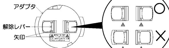
△埋込ローゼットの場合 アダプタのツメに本体のミゾが引っ掛かるように1段階押し上げる。
