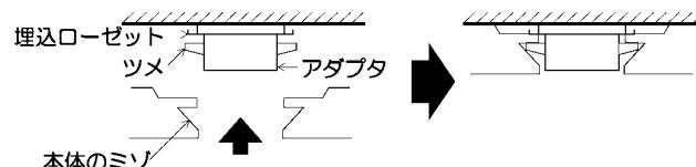
△その他の配線器具の場合 アダプタのツメに本体が引っ掛かるように2段階押し上げる。本体がガタつく場合は再度強く押し上げる。
