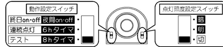
①電源投入後、約50秒間点灯し、その後テストモードになります。人を感知すると点灯時間が延長しますが、電源投入から約60秒後に一旦消灯し、テストモードになります。テストモードは人を検知することに約6秒間点灯します。結線および負荷の作動を確認できます。
