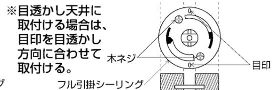
※目透かし天井に取付ける場合は、目印を目透かし方向に合わせて取付ける。
