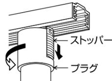
△警告 プラグのストッパーを操作する際は慎重に行なってください。プラグが損傷すると火災・落下によるけがの原因になります。
