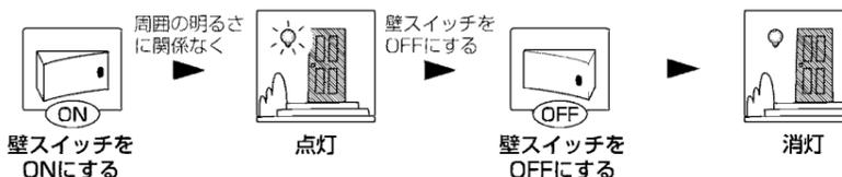
※電源投入後、約20秒間点灯し、その後約40秒間は明るくても人を感じることにより約5秒間点灯します。電源投入から約60秒後に一旦消灯し設定したモードになります。(連続点灯モードを除く。)
