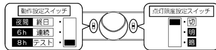
①電源投入後、約20秒間点灯し、その後は明るくても人を感知するごとに約5秒間点灯します。結線および負荷の作動を確認できます。
