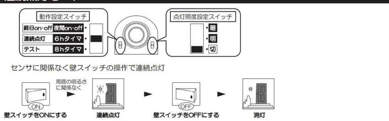
※電源投入から約60秒後に一旦消灯し、設定したモードになります。(連続点灯モードを除く。)
