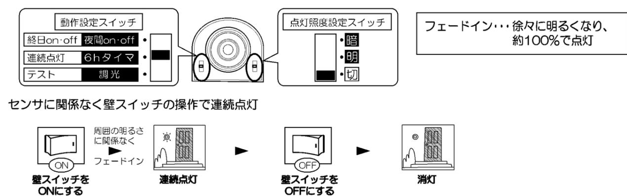
※電源投入後、約20秒間点灯し、その後約40秒間は明るくても人を感知することにより約5秒間点灯します。
