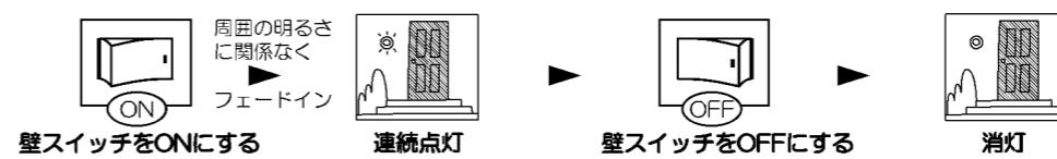
※電源投入後、約20秒間点灯し、その後約40秒間に明るくても人を感知するごとに約5秒間点灯します。
