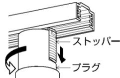
△ 警告 プラグのストップパーを操作する際は慎重に行なってください。プラグが損傷しますと火災・落下によるけがの原因になります。
