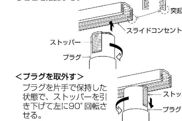
△警告 プラグのストッパーを操作する際は慎重に行ってください。プラグが損傷しますと火災・落下によるけがの原因になります。
