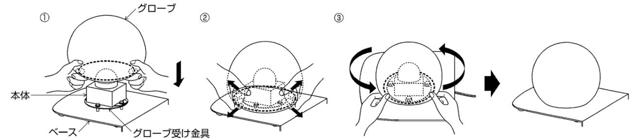
※取付け後、グローブが正しく取付けられているか、グローブがベースと接しているか確認してください。
