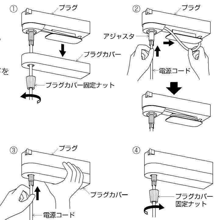
③微調整する場合、プラグカバーをプラグまで押し上げ、プラグカバーを押さえながら電源コードを押し込む。
