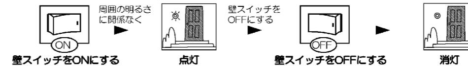
※電源投入後、約20秒間点灯し、その後約40秒間に明るくても人を感知するごとに約5秒間点灯します。
