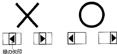
△警告 緑の先端が両端にくるまで本体を押し上げててください。取付けが不完全な場合、落下によるけがの原因になります。
