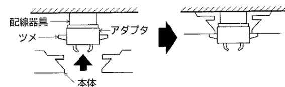
※本体を取付けた後、本体が安定しないときは、ノックアウト穴を利用し、取付ネジ(市販品)で止める。
