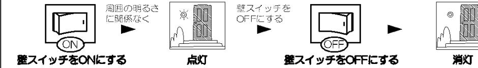
※電源投入後、約20秒間点灯し、その後約40秒間に明るくても人を感知することに約5秒間点灯します。
