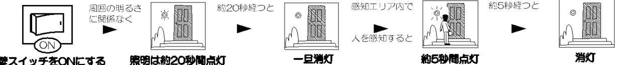
●センサを動かして感知エリアを調整できます。
