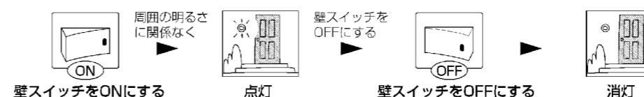
※電源投入後、約50秒間点灯し、その後センサ待機モードになります。
