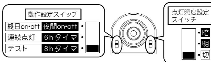
①電源投入後、約50秒間点灯し、その後テストモードになります。
