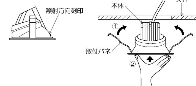
※天井材厚が薄い場合、天井との間にすきまが空くことがありますので、この場合は一度バネを押し広げてから埋込穴に挿入してください。
